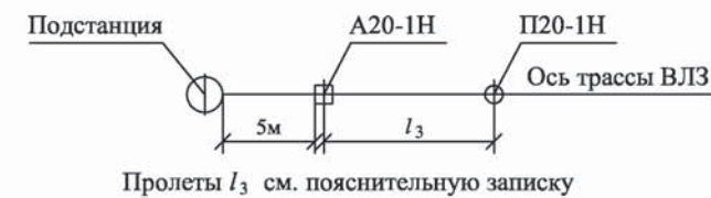
Схема 2 установки на ВЛЗ А20-1Н в качестве концевой опоры
